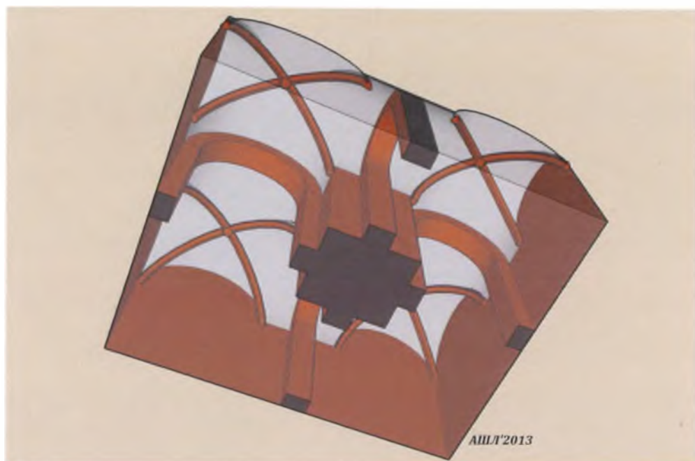
Мал. 2. Рэканструкцыя скляпенняў ніжняга яруса Княжскай вежы Круйскага замка. XIV–XV стст. Архітэктар Андрэй Шулаеў
